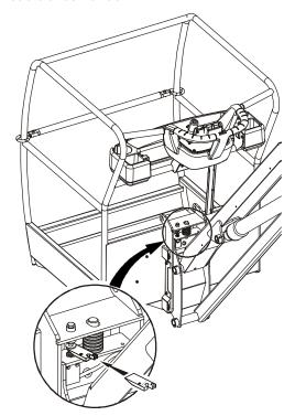
Figure 2-4. Overload Sensor
