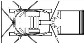
Figure 3-21. Machine Tie-Down - 10E/26E
